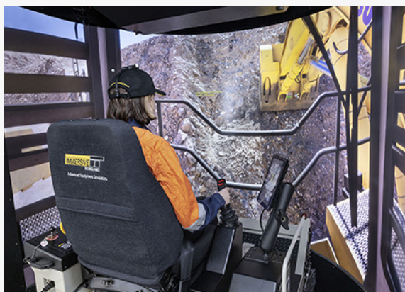
Симулятор гидравлической мехлопаты / экскаватора Komatsu PC7000-11 (дизельное исполнение), гидравлических мехлопат PC8000E-6, PC7000E-11 (электрическое исполнение) и симулятор шахтной погрузочно-доставочной машины Sandvik Toro LH517i.
